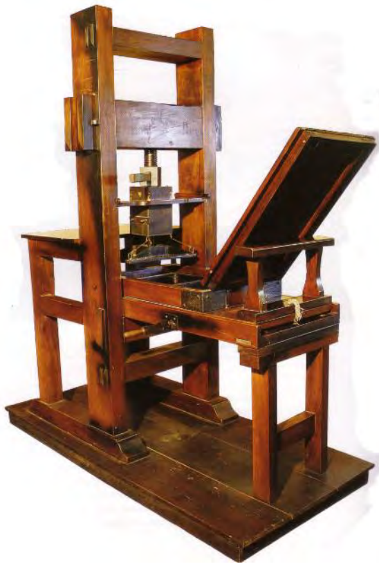
Réplica de 1964 de prensa tipográfica, tamaño natural, construida en madera en Guatemala, con base en unos planos de una prensa de los tiempos de Gutenberg.
